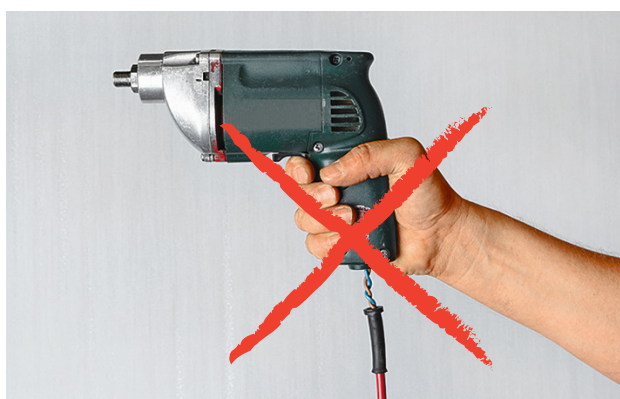
4 Câbles et outils défectueux: danger d'accident!
